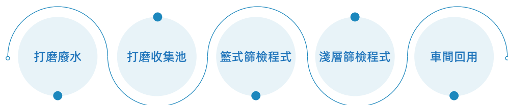
打磨廢水回用項目工藝流程
